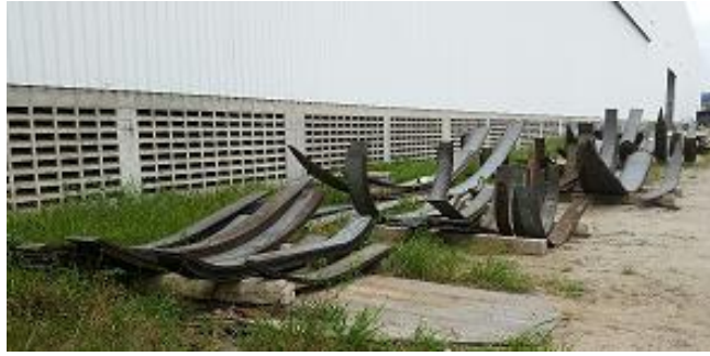
Figura 26 - Estoque excessivo de barras conformadas. (Fonte: AUTOR).
