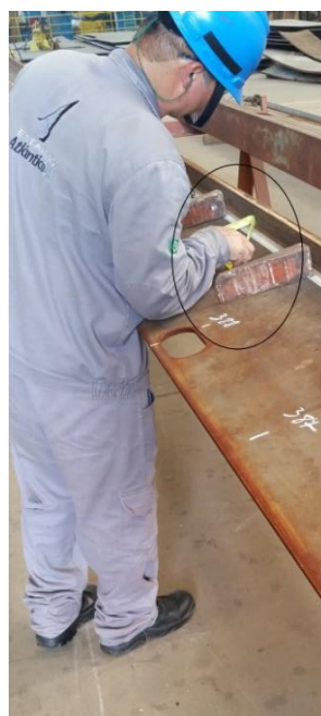
Figura 25 - Processo de marcação da contra curva. (Fonte: AUTOR).
